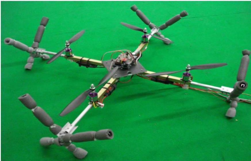
Figura 58 - QuadRotor desenvolvido
