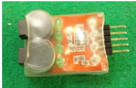
Figura 32 – Monitor de bateria com besouro
