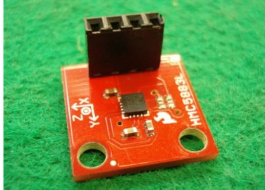
Figura 41 - Bússola digital HMC5883L
