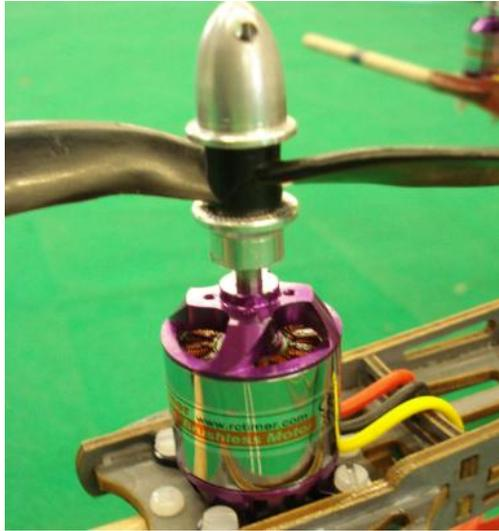
Figura 21 - Motor *BLDC* 880KV
