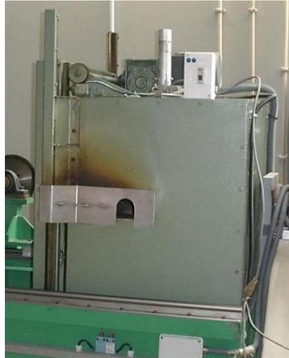
Figura 28 Máquina de Moldação Rotacional – Forno
