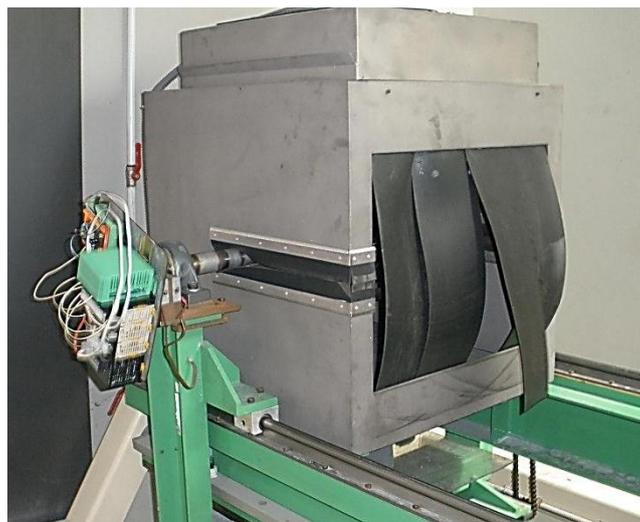
Figura 29 Máquina de Moldação Rotacional – Câmara de arrefecimento
