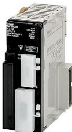
Figura 36 Autómato OMRON CJ1M-CPU11 [15]
