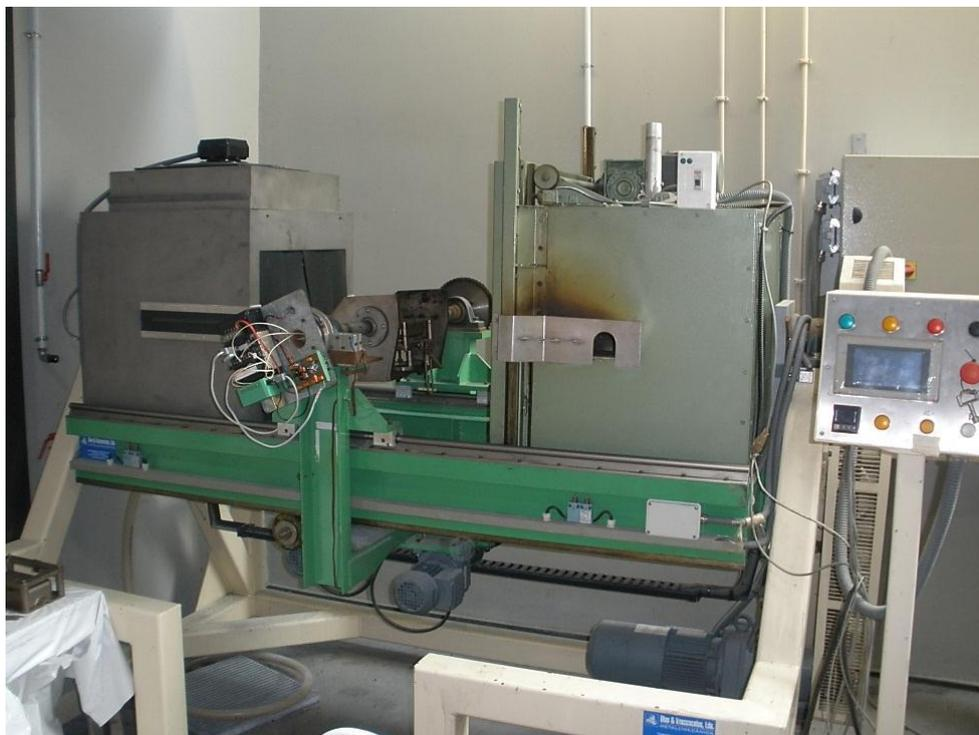
Figura 1 Máquina de Moldação Rotacional
