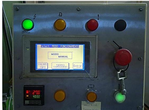
Figura 32 Máquina de Moldação Rotacional – Painel de controlo
