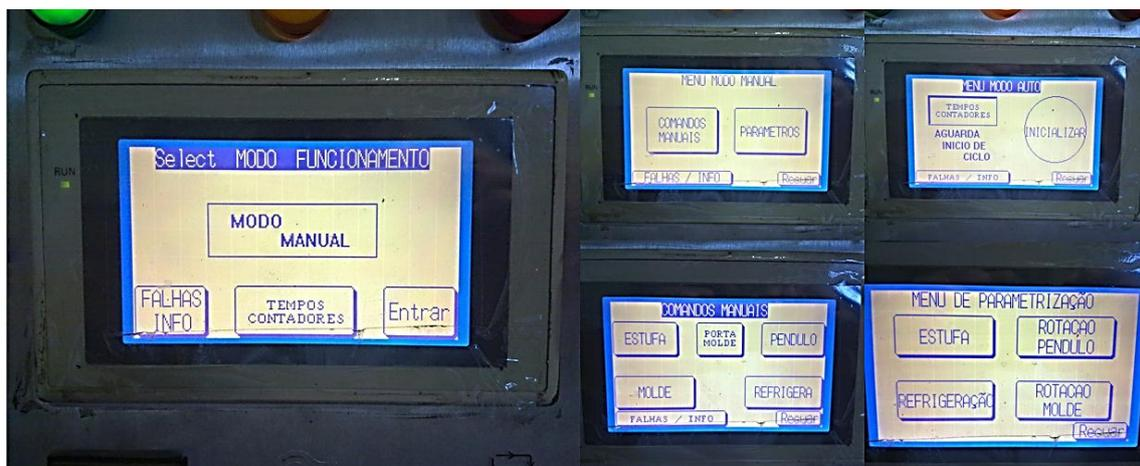
Figura 33 Máquina de Moldação Rotacional – Painel de controlo (opções)
