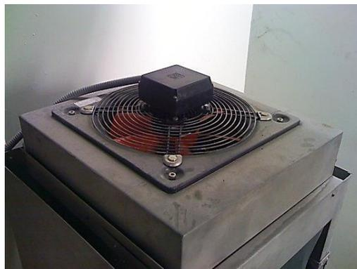
Figura 31 Máquina de Moldação Rotacional – Câmara de arrefecimento (ar)
