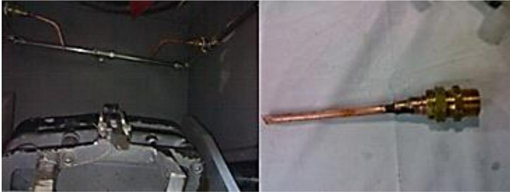
Figura 30 Máquina de Moldação Rotacional – Câmara de arrefecimento (água)
