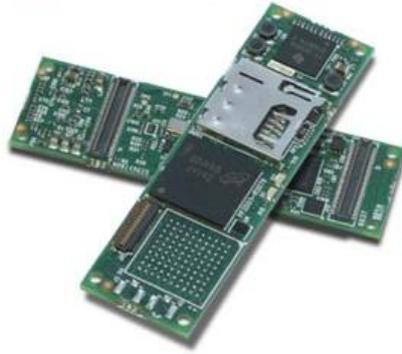
Figura 5 Sistema embebido Overo da Gumstix [8]
