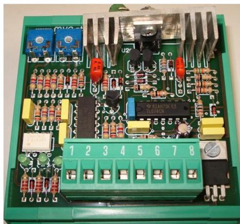
Figura 76 Placa de controlo dos motores DC
