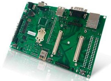
Figura 8 Placa de expansão para o sistema Armadeus [11]
