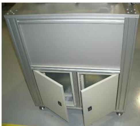
Figura 85 Estrutura inferior da célula de trabalho
