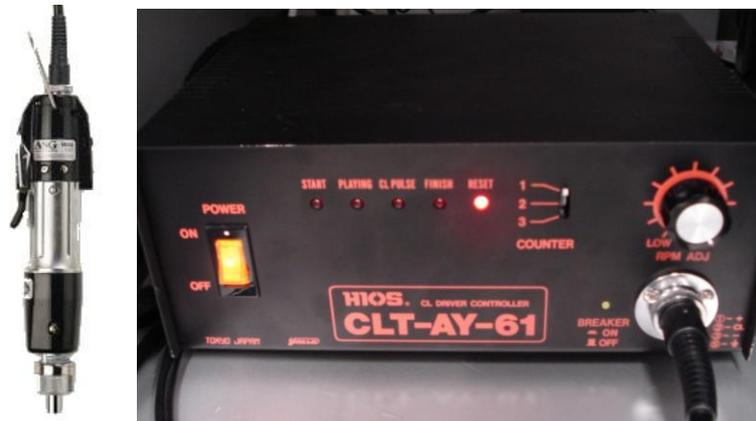
Figura 77 Aparafusadora eléctrica CL-6000 e controlador da marca HIOS
