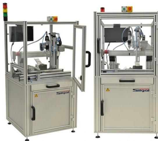
Figura 67 Célula de aparafusamento automático de PCBs
