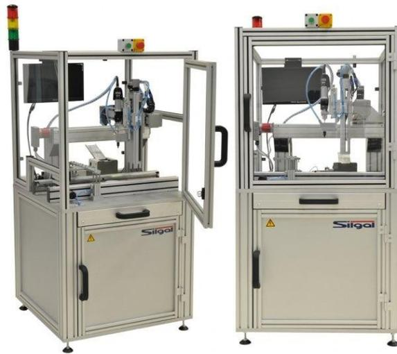
Figura 1 Sistema de aparafusamento automático de PCBs
