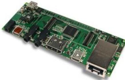
Figura 6 Placa de expansão Tobi para o sistema Overo [9]
