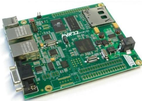
Figura 3 Sistema embebido da AVR32 NGW100 da Atmel [6]
