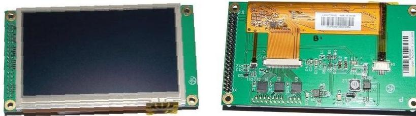
Figura 15 LCD de 4.3 polegadas da Toradex, com ligação directa à placa Orchid [19]
