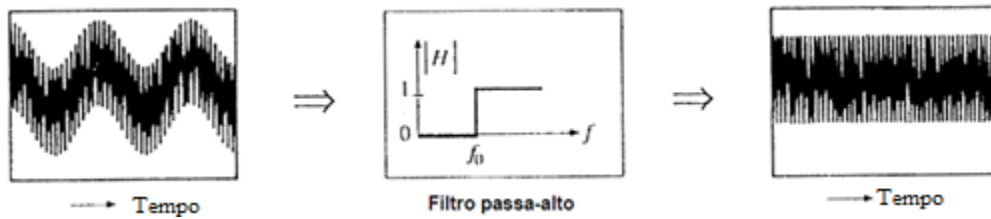
Figura 45 - Resposta de um filtro passa-alto no domínio do tempo [39]
