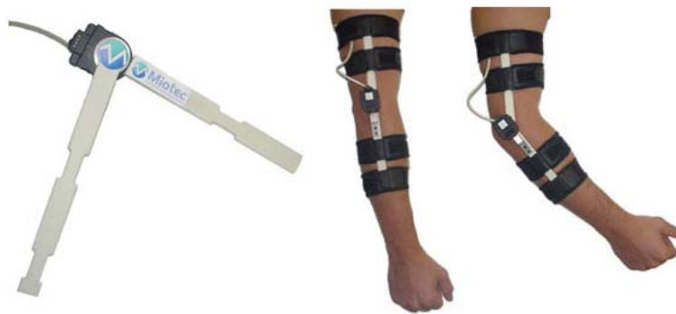
Figura 21 - Electrogoniômetro e seu posicionamento [31]
