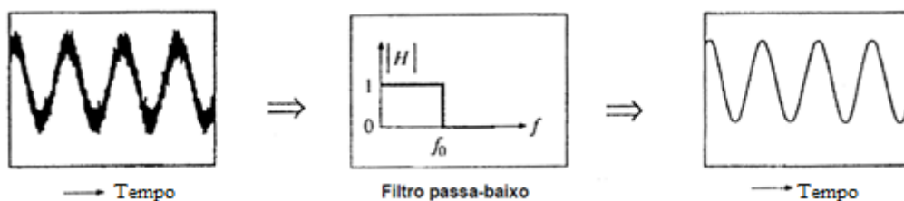
Figura 41 - Resposta de um filtro passa-baixo no domínio do tempo [39]
