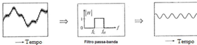
Figura 49 - Resposta do filtro passa-banda no domínio do tempo [39]
