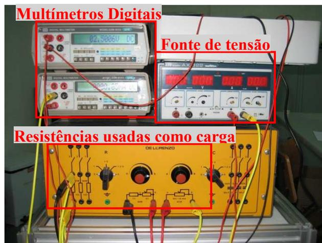
Figura 4.21 – Equipamento usado para testar sensores de corrente.
