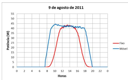
Figura 5.1 – Potência produzida pelos painéis ao longo do dia em 9 de agosto de 2011.
