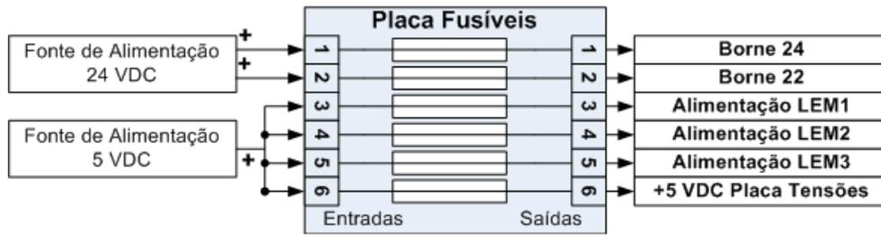
Figura 4.11 – Ligações da placa de circuito impresso (PCI) de proteção.
