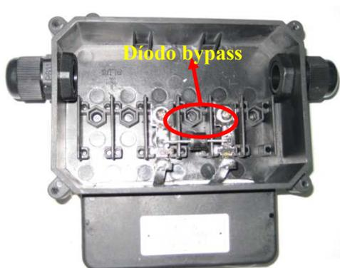
Figura 4.5 – Diodo de *bypass* na caixa de ligações do painel solar fotovoltaico ET-M53650.
