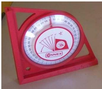
Figura 4.32 – Inclinómetro usado para ajustar a inclinação dos painéis fotovoltaicos.
