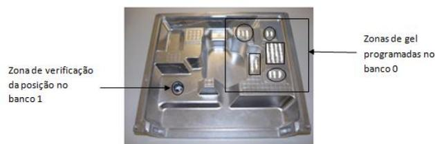
**Figura 2.18 - Tampa da centralina com as respectivas zonas de gel e posição programadas, estas zonas variam com a gama de centralina a assemblar.**
