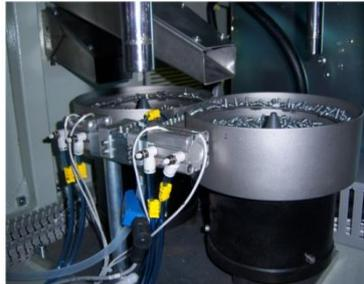
Figura 2.14 - Depósitos de parafusos.
