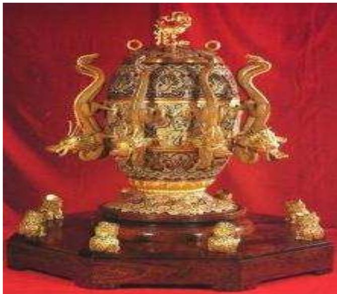
Figura 3-5: Sismocópio, o primeiro sísmografo. Este aparelho consistia numa bola em bronze sustentada por oito dragões que a seguravam com a boca [6].
