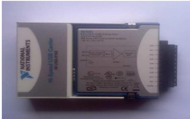
Figura 5-9: Placa de aquisição da National Instruments NI USB-9201.
