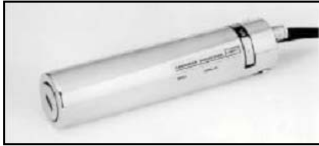
Figura 1.14 Detectores de NaI(Tl) da Canberra com tubo fotomultiplicador Amperex XP1010 [18].
