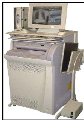
Figura 1.7 Equipamento para leitura de placas de fósforo e produção de imagem digital (Fonte: NDT- FUJI)
