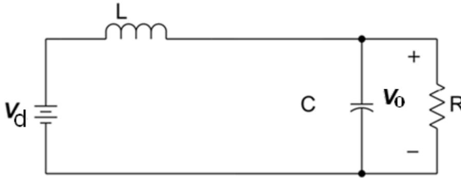
Figura 3-4 Estado de funcionamento *OFF* [44]
