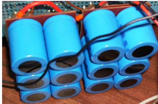
Figura 4.16 – Bateria de Condensadores.
