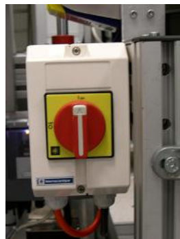
Figura 5-4: Corte geral da alimentação eléctrica.
