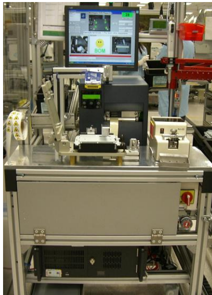
Figura 7-1: Posto de montagem da tampa superior do mecanismo.
