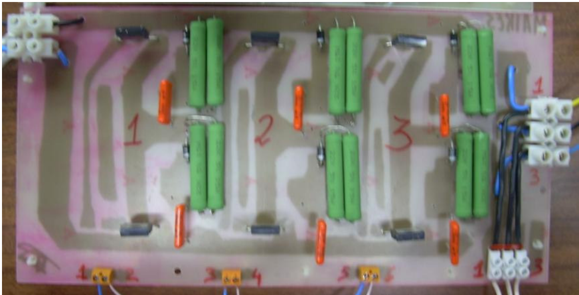
Figura 4.30 – Inversor trifásico implementado
