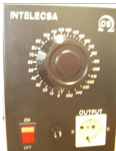
Figura 4.3 – Variac monofásico pala alimentar ponte rectificadora
