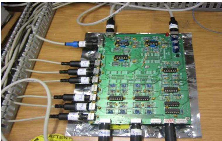
Figura 5.15 - Circuito de Condicionamento de Sinais.
