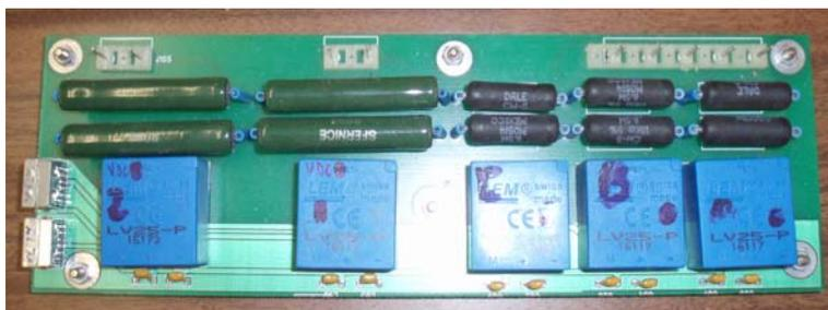
Figura 5.14 - Placa para fazer a aquisição dos sinais de tensão.
