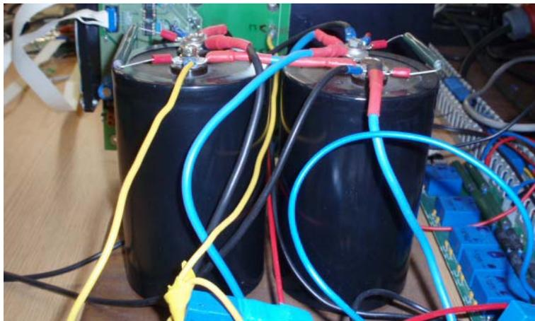
Figura 5.10 – Condensadores aplicados ao do lado CC do inversor filtro activo.
