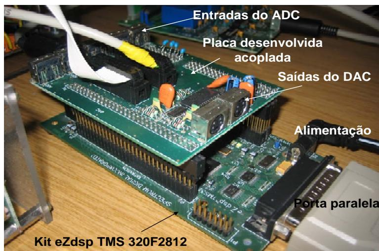
Figura 5.17 – kit eZdsp2812 com placa desenvolvida acoplada.
